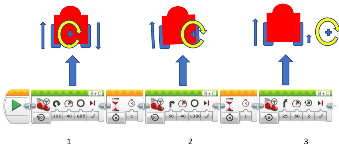
1.- En el bloque con el número 1, hacemos que la rueda izquierda va a una potencia de 40, mientras la rueda derecha va a una potencia de -40, durante 685 grados, realiza una rotación sobre sí mismo.
